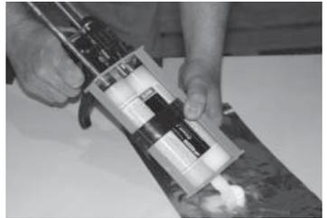
FIGURE 13: LEVELING THE PLUNGERS
